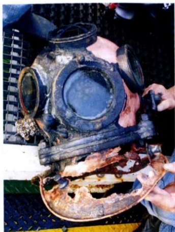
Hjelmens brystplade var tæret ved kontakt med andre metaller. Herudover var hjelmen intakt.
