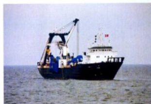
MS Vina er dansk indregistreret og bygget i 1978 i Norge. Længden er 76,7 meter og bredden 14 meter. Tonnagen er på 2.065 tons og der er kahytsplads til 24 mand.
